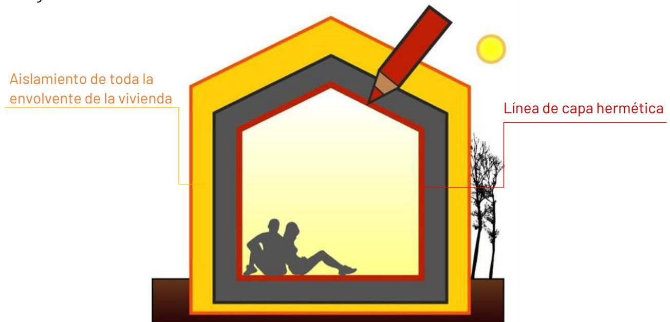
La **hermeticidad** es un concepto nuevo en viviendas pasivas con respecto a la construcción tradicional. Consiste en que la capa interior del muro sea hermética para limitar al máximo la entrada del aire exterior y salida del aire interior. Estos trabajos se realizan mediante encintados, membranas y complementos de la marca SIGA.
